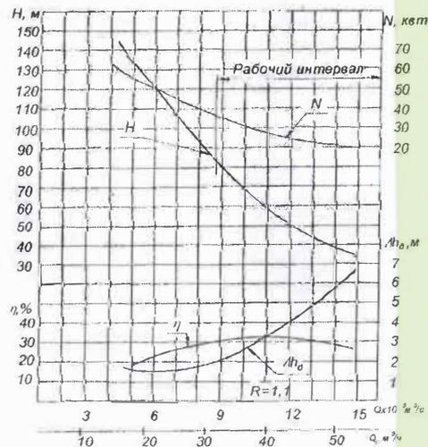
Рисунок Б.2 - Характеристика самовсасывающих насосов ІСЦЛ 20-24І М(С,Р,К), испытанных на воде с плотностью  $\rho=1000 \text{ кг/м}^3$ ,  $n=28,33 \text{ с}^{-1}$  (1700 об/мин)
