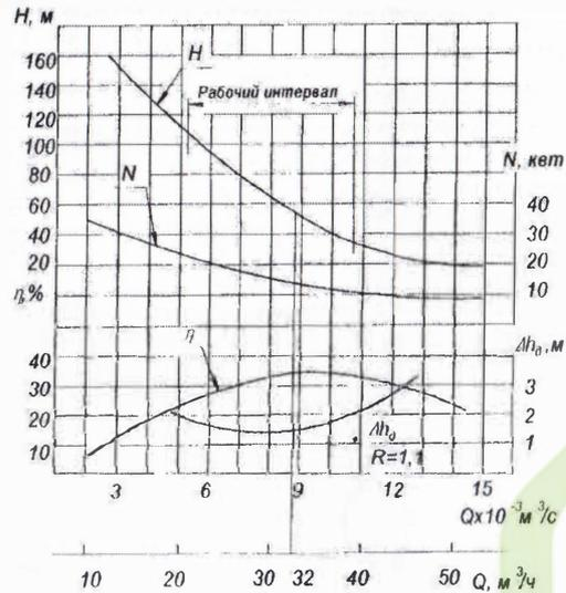
Рисунок Б.1 - Характеристика самовсасывающих насосов ІСЦЛ 20-24І М(С,Р,К), испытанных на воде с плотностью  $\rho=1000 \text{ кг/м}^3$ ,  $n=24,17 \text{ с}^{-1}$  (1450 об/мин)
