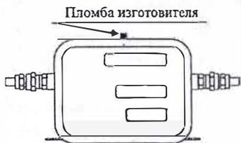
Рисунок 9 – Схема пломбировки ВП КУП
