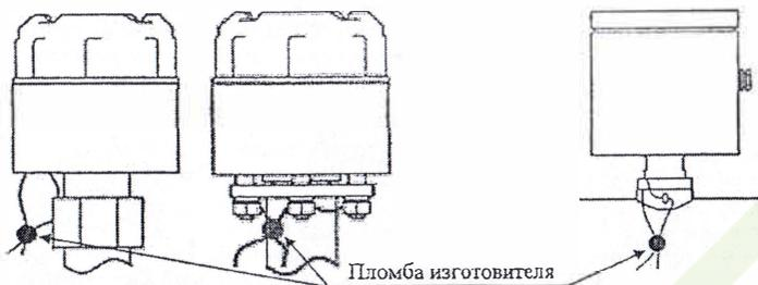
Рисунок 5 – Схемы пломбировки ВП ДИ-О-5
