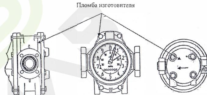
Рисунок 1 – Схемы пломбировки ППО
